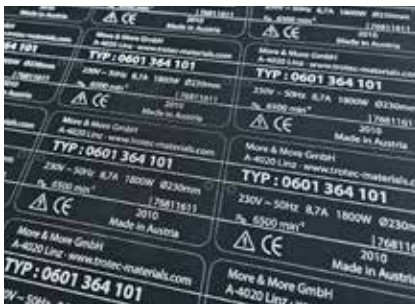
Herstellung von Typenschildern durch direkte Markierung von Metallen
