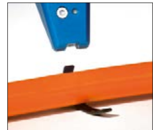
... Une fois la bande coupée, dégager l'outil et récupérer le résidu de collier.
