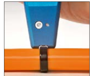
... exercer une légère pression pour que la bande pénètre correctement dans la gorge de l'outil...
