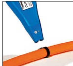
Amener l'outil, perpendiculairement, au contact du collier...
