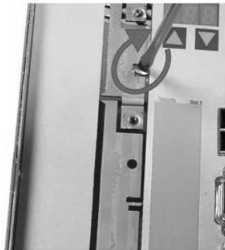
4 - Break the top rib
