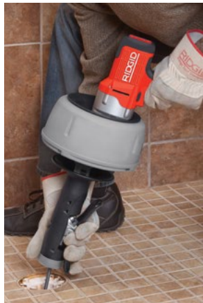
Die 3/8" (10 mm) Spirale im Modell K-45AF-5 erweitert die Kapazität der Maschine auf 2 1/2" (75 mm) Abflussleitungen.
