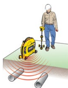
Induzieren eines Signals zur Lokalisierung von Versorgungsleitungen.
