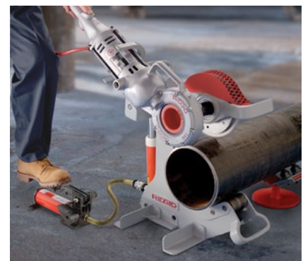
Elektro-Rohrabschneider Modell 258 mit Kraftantrieb Modell 700 beim Schneiden
