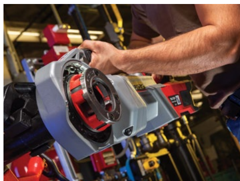
760 FXP™ Kraftantrieb mit Akku und Ladegerät, (1/2" - 2") Schneidköpfe mit HS Schnellstahlbacken, Stützarm, Koffer
