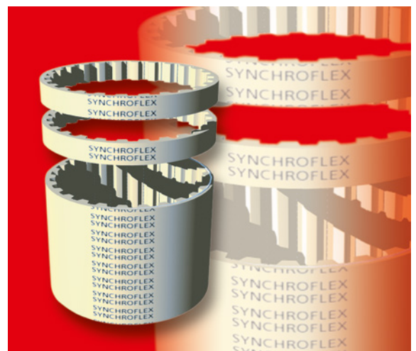
Entformter Zahnriemenwickel, teilweise in individuelle Riemen getrennt
