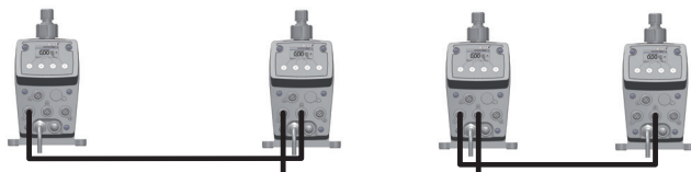
Abb. 17: Synchronisation mehrerer Dosierpumpen über Hubrückmeldung und Impulssteuerung
