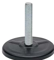
Part. R0031 - Pag. R53 Ø 110 • Rubber • Max. load 6000 N.
