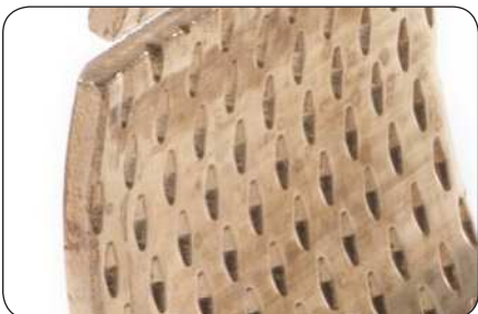
Rautenförmige Schmiertaschen in der Gleitfläche
