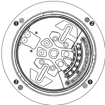
Bild 6 Sockel USB 502-2 med manschett sedd uppifrån (undertak, infälld)
