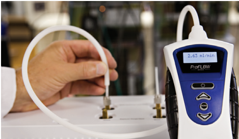
图 4：探管连接到 GC 气体出口。
