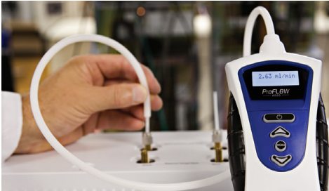
Abbildung 4: Prüfspitze an einen GC Gas Outlet anbracht
