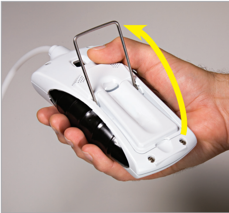
Figure 2 : Déployer le support métallique pour accéder au compartiment des piles.
