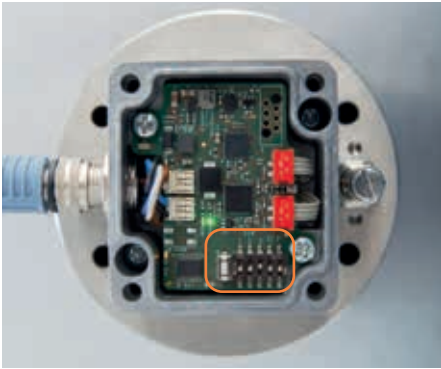
Die Standard-Darstellung befindet sich ebenfalls im Deckel des Vorverstärkers, um die Einstellungen direkt vor Ort ändern zu können.
