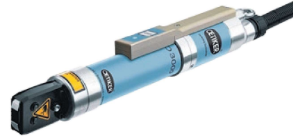
oder mit Auslöseeinheit ELT Ergonomische Handhabung (ELT = elektronische Ausführung mit Tastverlängerung)
