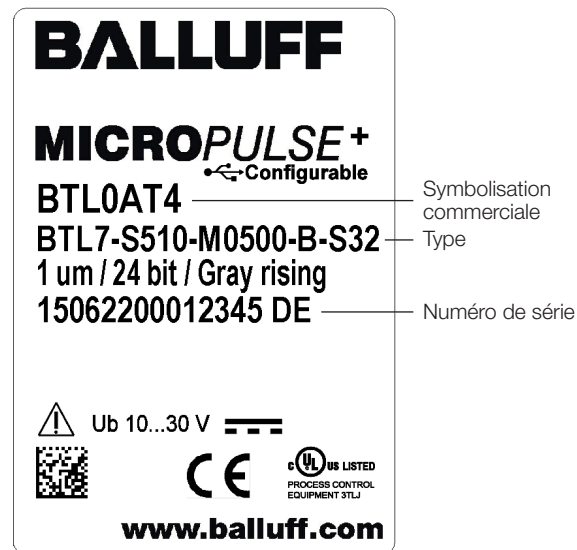
Fig. 11-2: Plaque signalétique BTL7-S510-... (exemple)
