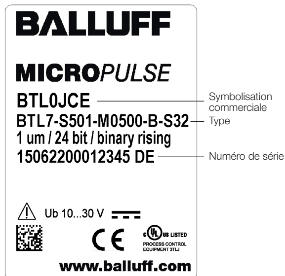
Fig. 11-1: Plaque signalétique BTL7 Standard (exemple)
