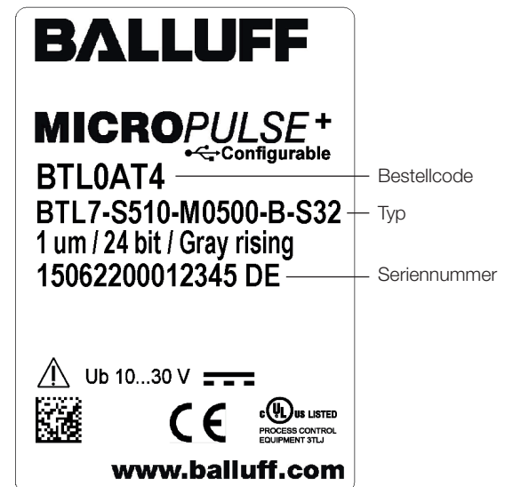
Bild 11-2: Typenschild BTL7-S510-... (Beispiel)
